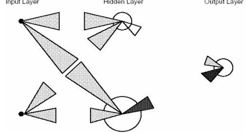
Visualizza i pesi direttamente sulla topologia della rete. I bias weights sono mostrati con cerchi di vario diametro, il colore bianco/nero indica peso positivo/negativo, la dimensione del triangolo indica la forza del peso.
